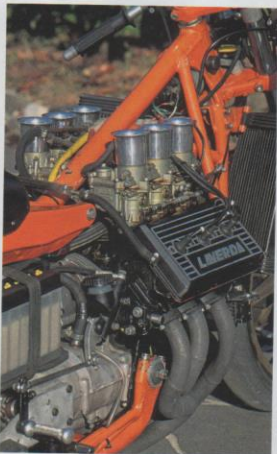
Zwei Dreier-Bänke sind im 90-Grad-Winkel zu 996 cm 3 arrangiert. Be-atmet werden sie von Dell'Orto-Vergasern
